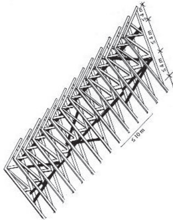
Kuva 10a. Yläpaarteiden asennusajainen tuenta
